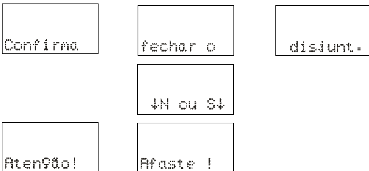
Figura 3.10: Comando local para fechar o disjuntor.
