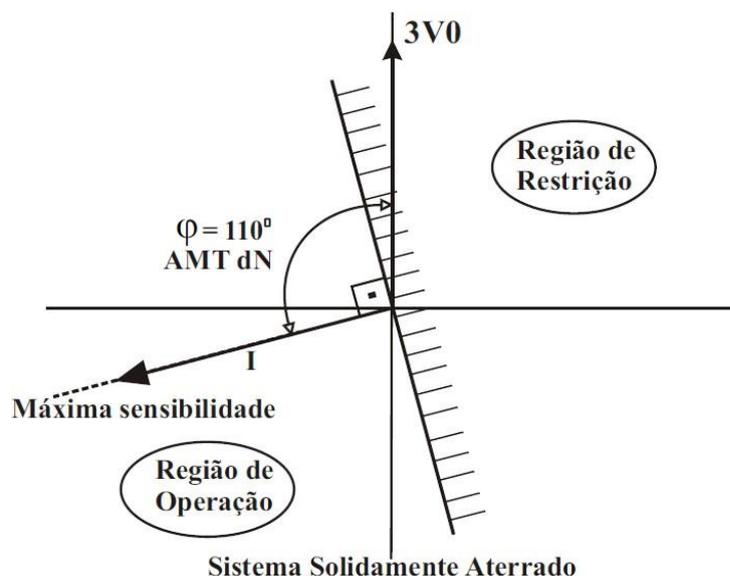
Figura 10.5: Falha à terra para sistema solidamente aterrado.
