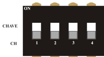
1 – a chave dip interna CH posição 4 em **OFF** desabilita a programação do relé através do teclado.
