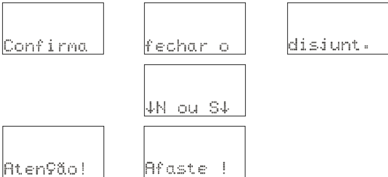
Figura 3.10: Comando local para fechar o disjuntor.
