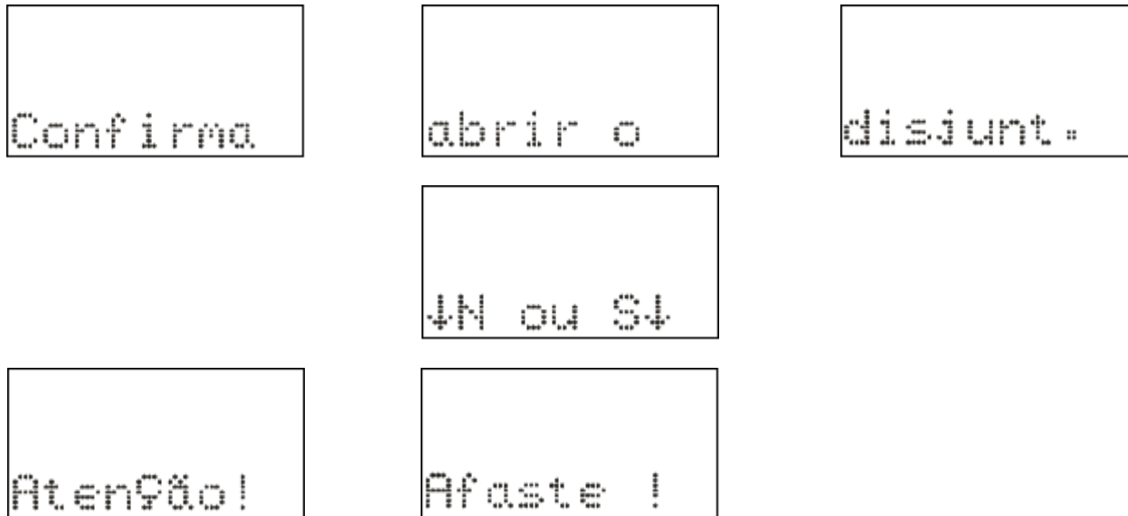
Figura 3.12: Comando local para abrir o disjuntor.
