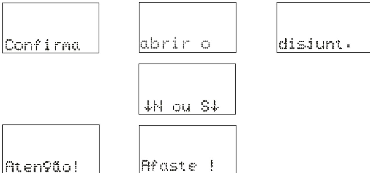
Figura 3.12: Comando local para abrir o disjuntor.
